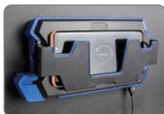
Les deux chargeurs sont équipés d'un dispositif escamotable pour recharger les portables.
