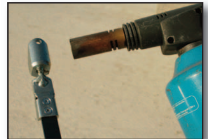
Efectúe sus perforaciones en poliestireno blanco o gris, en todas las direcciones. Pasa por: 1 conducto de Ø 25 o 1 de Ø 20 o 2 de Ø 16. La forma biselada del cabezal calefactor (cabezal PC2005) permite presionar el cabezal contra la placa de yeso adherido al revestimiento sin crear puentes térmicos (el aislamiento permanece detrás de la canalización).
